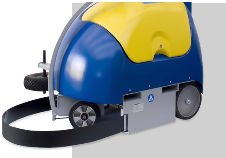
Rammschutz zur Vermeidung von Kollisionen und Beschädigung des Packstücks
