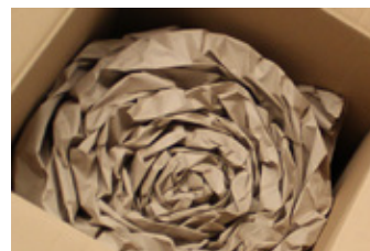
Papierrollen sparen wertvolle Lagerfläche - Polster haben bis zu 60-faches Volumen des Ausgangsmaterials
