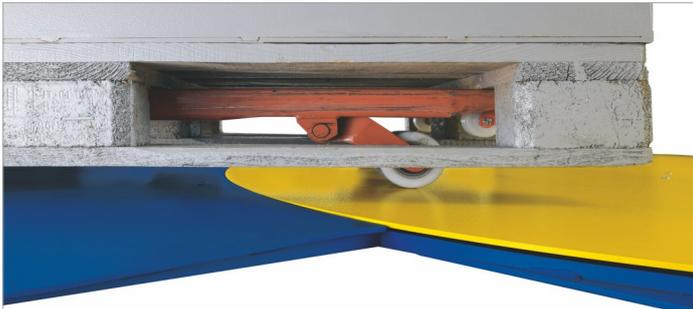
Ein Näherungssensor sorgt für einen exakten Stopp in der Nullposition am Ende eines jeden Wickelzyklus. Dadurch kann die Palette ohne Probleme in der gleichen Position entnommen werden, in welcher sie auf den Drehteller gestellt wurde.
