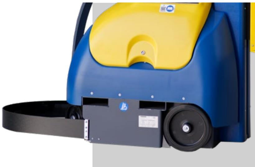
Rammschutz zur Vermeidung von Kollisionen und Beschädigung des Packstücks
